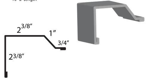
**Endwall Flashing** <sup>14</sup>
